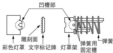
【注意】弹簧具有方向性，拆除后请按原样插入。（请将弹簧先端的卷起部与灯罩架的咬合槽咬合。）文字标记牌的雕刻面有上图所示的方向性。
