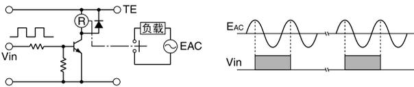
当继电器的触点与电源电压同步开闭时，会消耗继电器的使用寿命。此时，请根据电路所需要的稳定性选择继电器。或者将开闭时的位相设置成随机或使其在零位相附近开闭。
