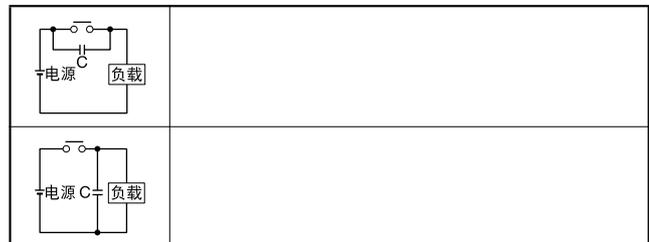
通常开闭DC电感负载比开闭DC电阻负载困难。但如果使用适宜的电弧抑制器可以改善DC电感负载的开闭性能，使其达到与电阻负载同等程度。
