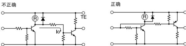
在继电器工作的同时操作其他信号时，需注意电路设计。例如，上面不正确的电路图，当继电器关闭时会有泄漏电流  $I_o$  通过继电器线圈，从而引起线圈的复归故障，耐振动、抗冲击性能低下。
